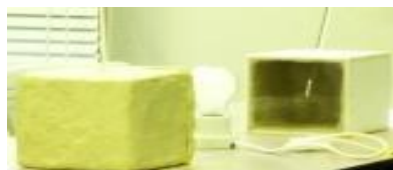
図2 外断熱(外側粘土)・内断熱(内側粘土)
