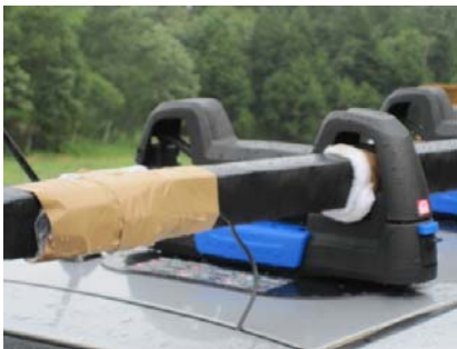
図 2 : USB ガイガーカウンターと DoseRAD2 を取り付けた様子
